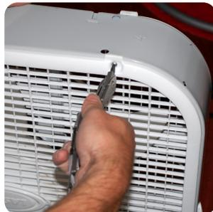
Vuelva a atornillar la parte delantera al ventilador.
